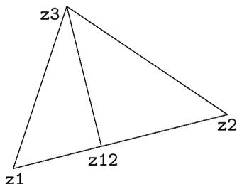
Příkaz `show z12/mm, abs(z12-z3)/mm` způsobí, že během překladu zdrojového textu programem METAFONT se na obrazovce objeví souřadnice bodu `z12` a velikost výšky v milimetrech:
