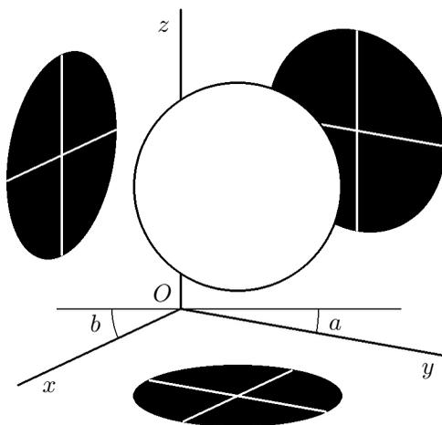
Obrázek 2: Axonometrické zobrazení koule a jejích průmětů
